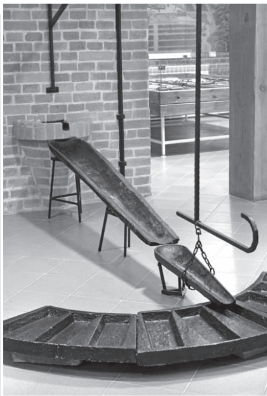
Изложницы, в которые разливалась медь из шплейзофена. Из экспозиции музея «Медеплавильный завод»
